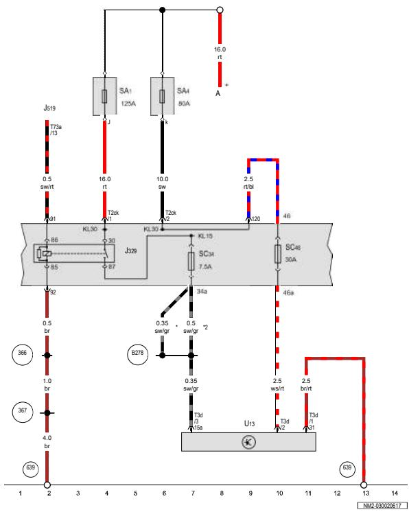
接线端 15 供电继电器, 带插座的逆变器
